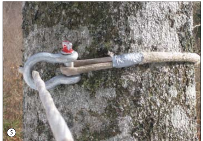
Abb. 2: Das Anschlagseil wird um den Stammfuß gelegt und mit Hilfe eines Schäkels zu einer Schlinge verbunden. Der zweite Schäkkel stellt die Verbindung zum Windenseil her.
