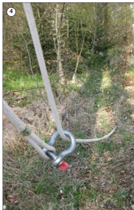
Abb. 2: Das Anschlagseil wird um den Stammfuß gelegt und mit Hilfe eines Schäkels zu einer Schlinge verbunden. Der zweite Schäkkel stellt die Verbindung zum Windenseil her.
